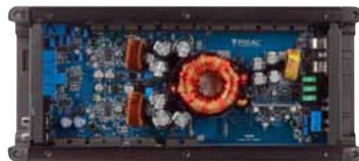
**Alles digital bei den FPX: Auch die vier kleinen Kanäle der FPX 5.1200 sowie die Vierkanalendstufe arbeiten nach dem effizienten Class-D-Prinzip**
